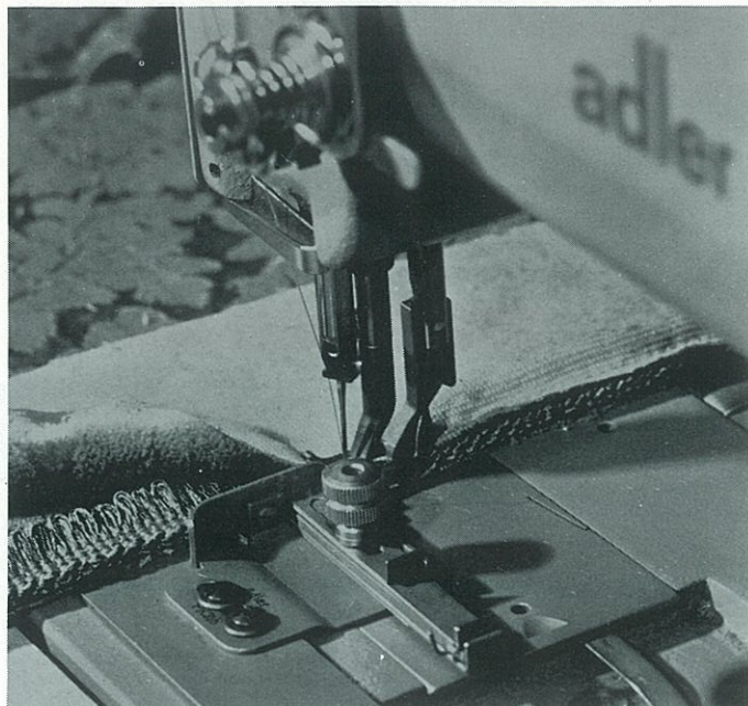
Adler 167-373 mit PK 31 b Marabu einnähen Inserting the braid Pose de galons Marabout Intercalando marabú
